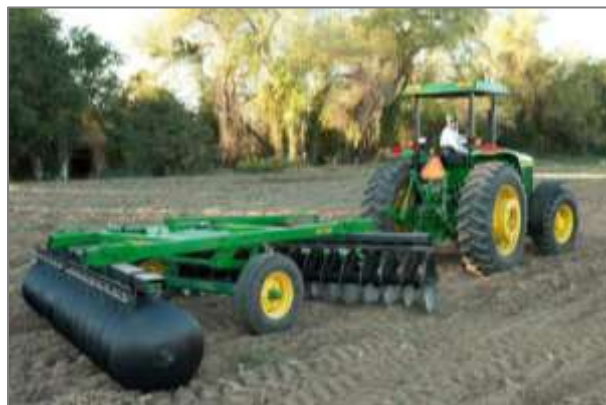
Figura 4. Rastra MX 225 (toma de fuerza 60-90 hp) Fuente: John Deere (2018)
