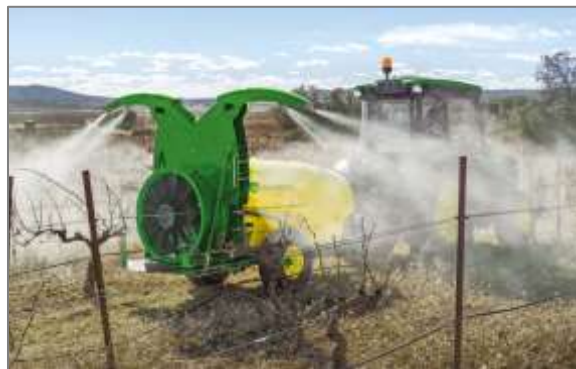
Figura 7. Pulverizadora aspersora M115 (tanque de 1500L)
