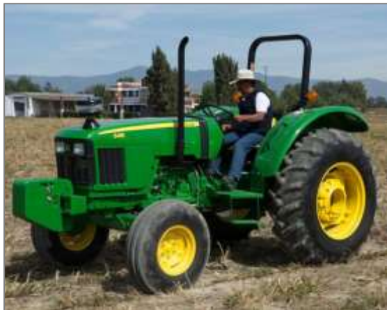
Figura 15. Tractor modelo 5415 (77hp al motor y 67 hp a la toma de fuerza) Fuente: John Deere (2020)
