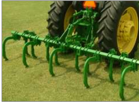
Figura 5. Cultivador MX10 (toma de fuerza 43-90 hp) Fuente: John Deere (2018)
