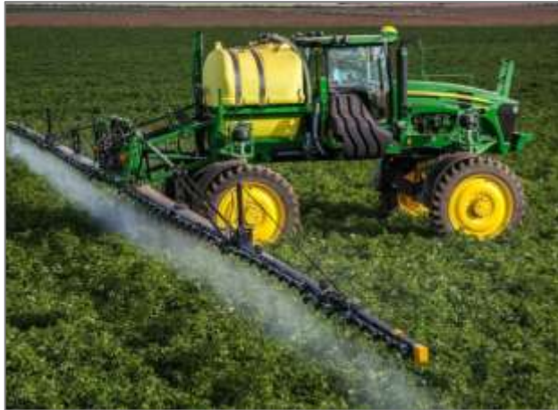
Figura 12. Pulverizadora autopropulsada modelo M4040 (278 hp) Fuente: John Deere (2020)
