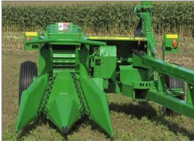
Figura 8. Cosechadora de arrastre de maíz forrajero (toma de fuerza 106 hp) Fuente: John Deere (2018)
