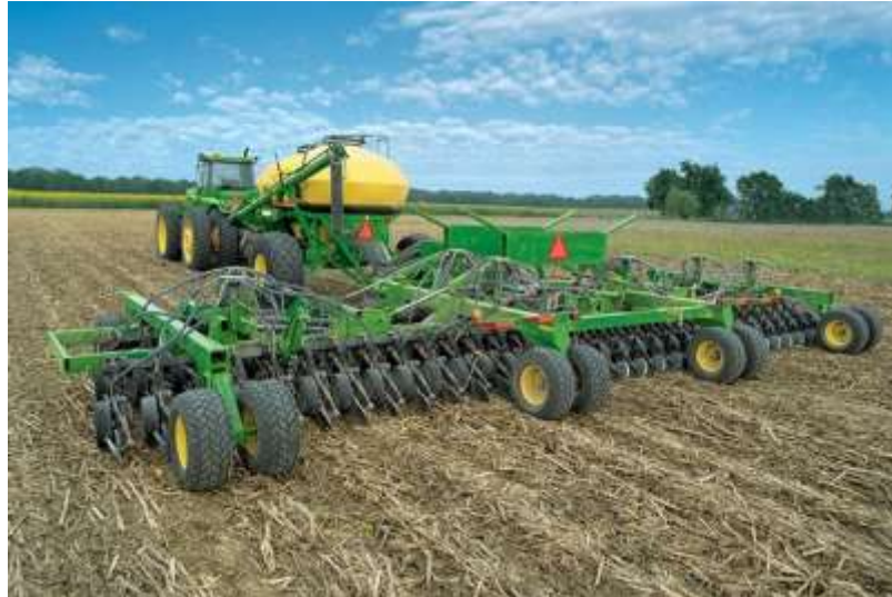
Figura 25. Imagen referencial del tractor 7230J con sembradora de granos Fuente: John Deere México, 2016
