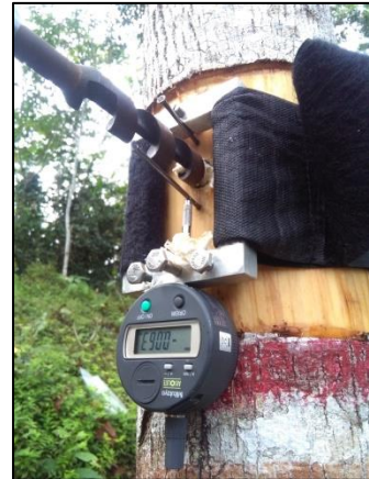
Figura 3: Tensiómetro ubicado en árbol en pie
