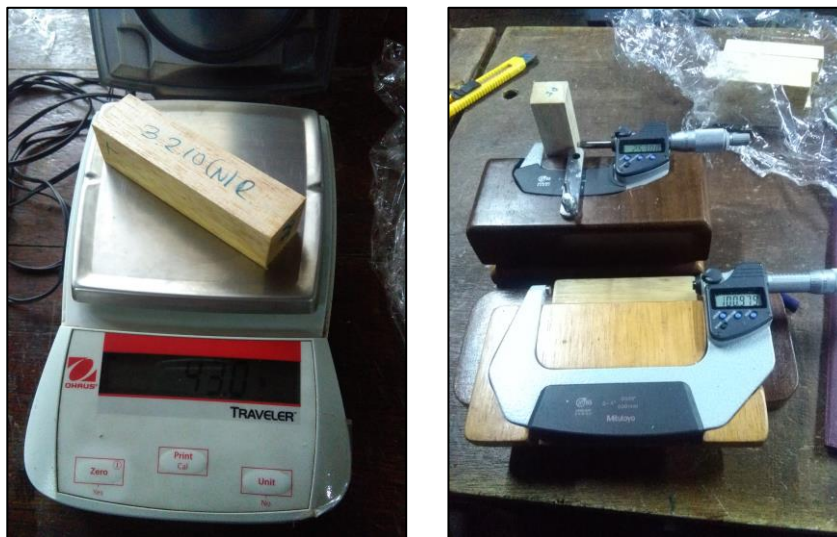
Figura 1: Pesaje y medición de las contracciones
