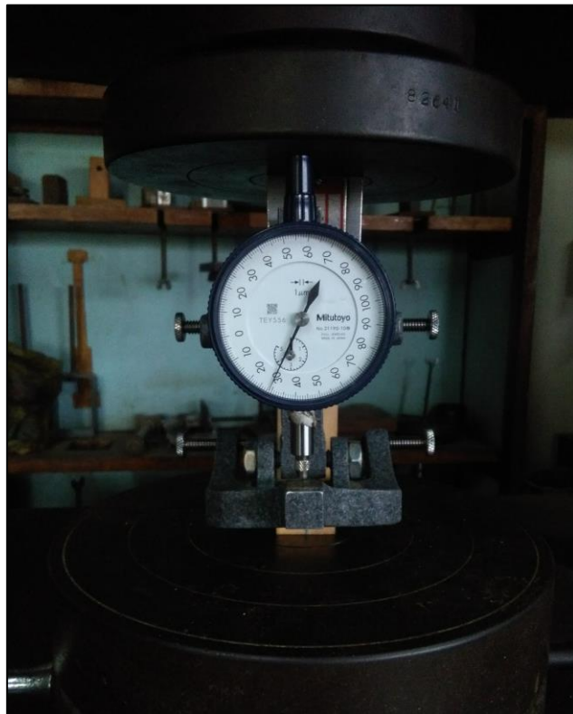
Figura 3: Ensayo de compresión paralela
