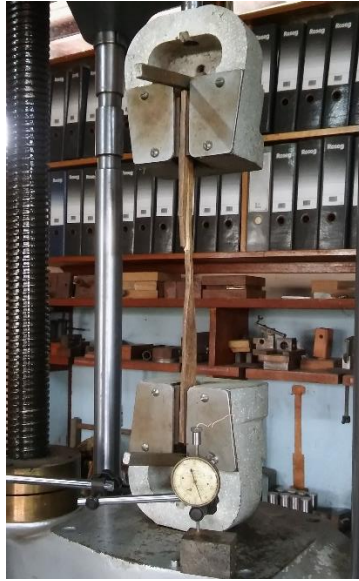
Figura 32: Ensayo de tensión de G. angustifolia .
