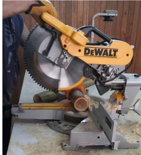
Figura 21: Uso de ingletadora telescópica para elaboración de probetas.
