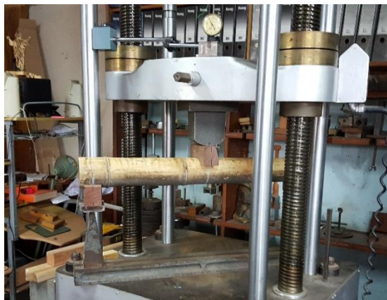
Figura 30: Ensayo de flexión estática de G. angustifolia .
