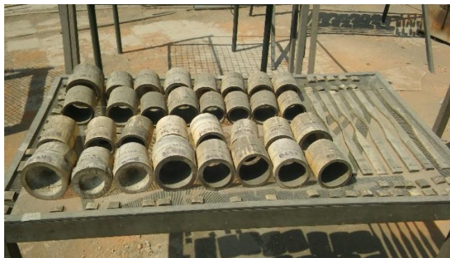
Figura 28: Probetas durante prueba de intemperismo (168 días = 20 de Nov.)
