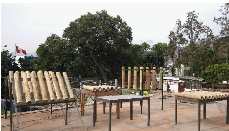
Figura 25: Acondicionamiento de mesas y caballetes para el ensayo de intemperismo.
