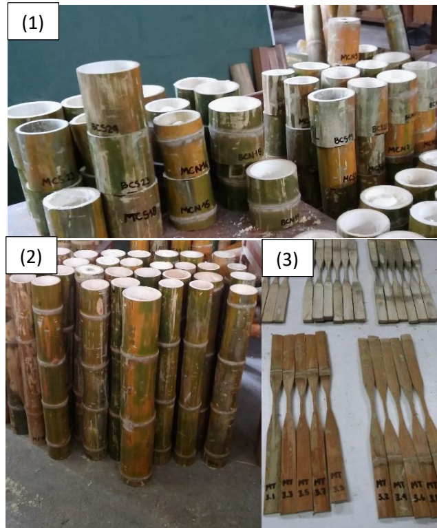
(1) Probetas para ensayos físicos y para el ensayo de compresión paralela, (2) Probetas para ensayo de flexión estática, (3) Probetas para ensayo de tensión.
