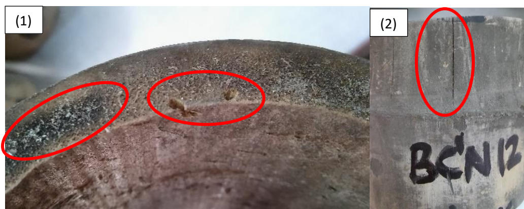
Figura 37: Probetas expuestas a intemperismo que presentan ataque de hongos e insectos (1), grietas (2).
