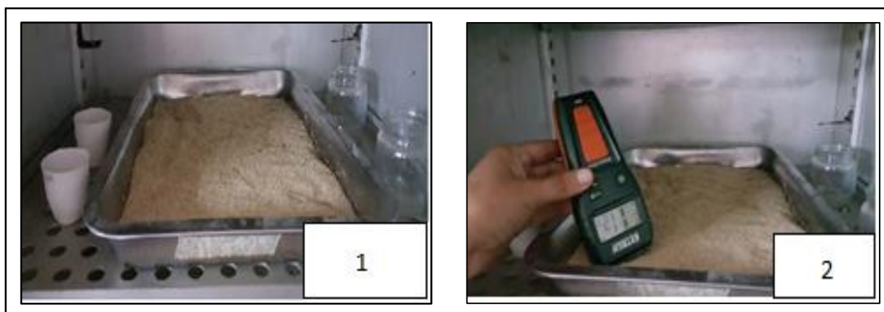
Figura 18: Humectación y control del contenido de humedad de las partículas
