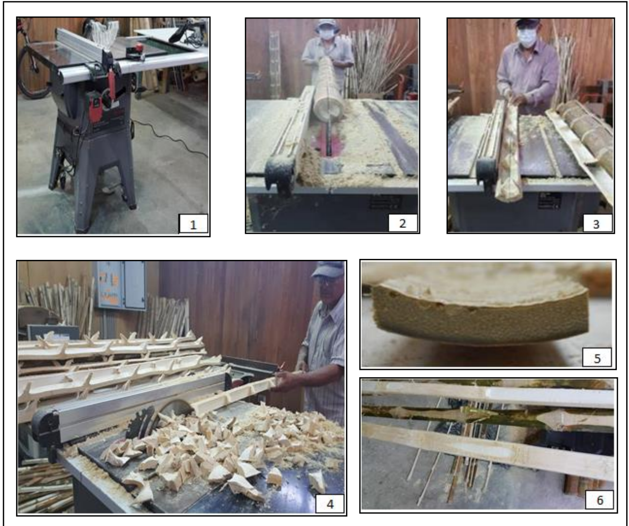
Figura 16: Figura 14: Aprovechamiento de las cañas de bambú para la elaboración de latas : (1)Sierra circular; (2) Corte longitudinal de la lata; (3) Corte longitudinal para la obtención de octavos; (4) Denudado; (5); vista transversal del listón; (6) vista longitudinal del listón
