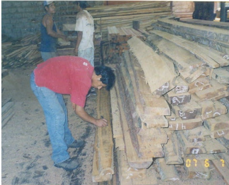
Codificación de los tablonés de teca a la salida de la sierra cinta.
