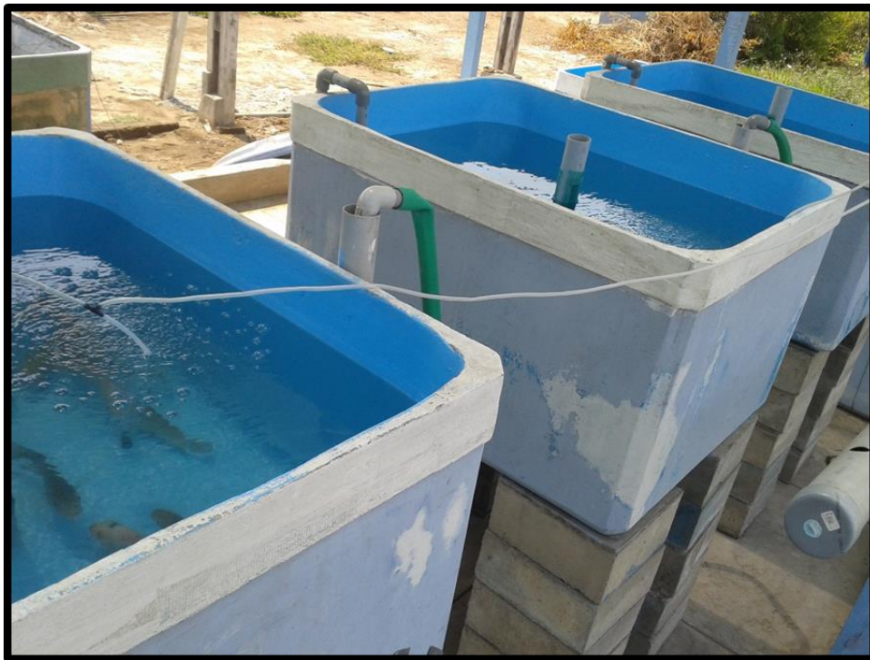
Figura 6: Tanques para el cultivo de peces, provistos de aireación, llaves de paso de agua y sistema de desfogue
