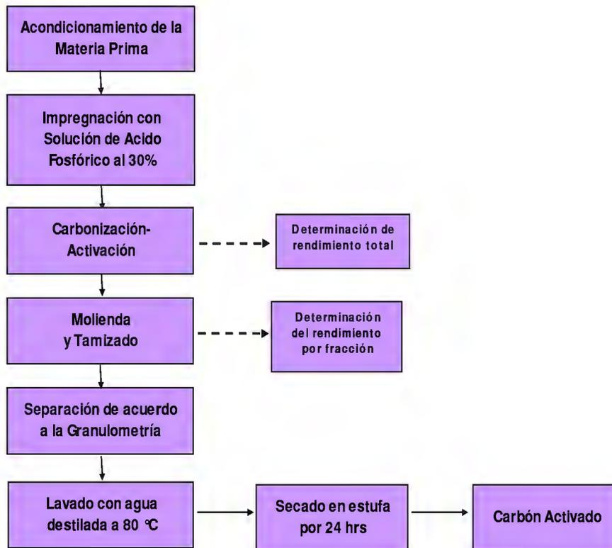
**Figura 12 :** Diagrama de la Metodología aplicada en la obtención de carbón activado y sus ensayos.
