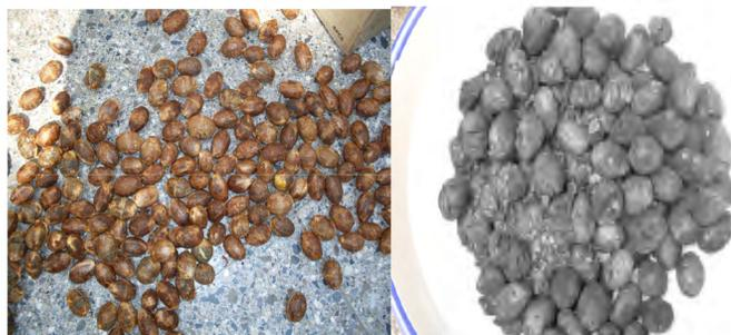
**Figura 9** : La semilla de Aguaje, antes y después de la Carbonización-Activación.
