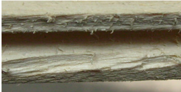
FOTO 1: DEFECTO DE GRANO ARRANCADO FUERTE EN EL ENSAYO DE MOLDURADO
