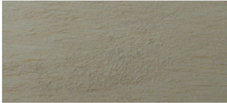
FOTO 1: DEFECTO DE GRANO VELLOSO FUERTE EN EL ENSAYO DE LIJADO
