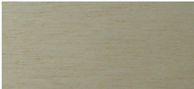
FOTO 3: DEFECTO DE GRANO VELLOSO SUAVE EN EL ENSAYO DE LIJADO
