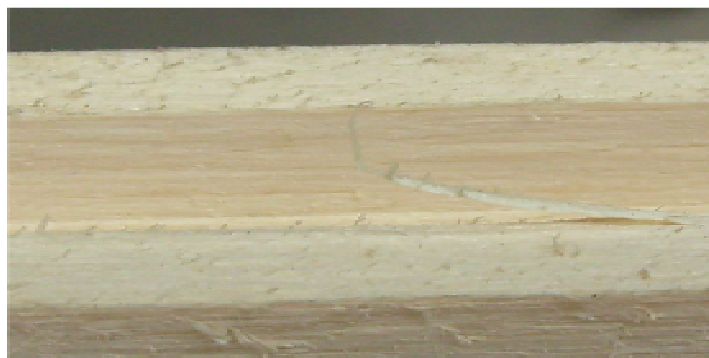
FOTO 9: DEFECTO DE GRANO LEVANTADO SUAVE EN EL ENSAYO DE MOLDURADO
