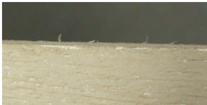
FOTO 12: DEFECTO DE GRANO VELLOSO SUAVE EN EL ENSAYO DE MOLDURADO
