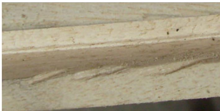
FOTO 3: DEFECTO DE GRANO ARRANCADO SUAVE EN EL ENSAYO DE MOLDURADO
