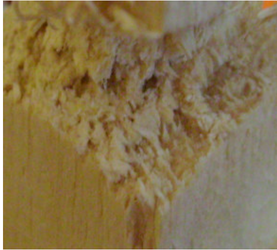
FOTO 1: DEFECTO GRANO ARRANCADO
