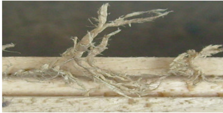
FOTO 4: DEFECTO DE GRANO ASTILLADO FUERTE EN EL ENSAYO DE MOLDURADO
