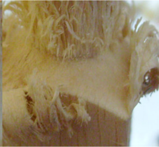
FOTO 2: DEFECTO GRANO ASTILLADO
