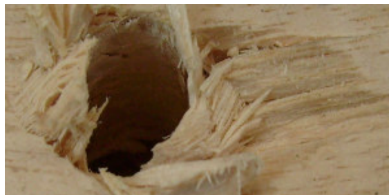
Figura 12 Defecto de ruptura de grano en el ensayo de taladrado
