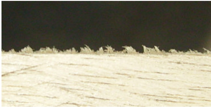
FOTO 11: DEFECTO DE GRANO VELLOSO MODERADO EN EL ENSAYO DE MOLDURADO
