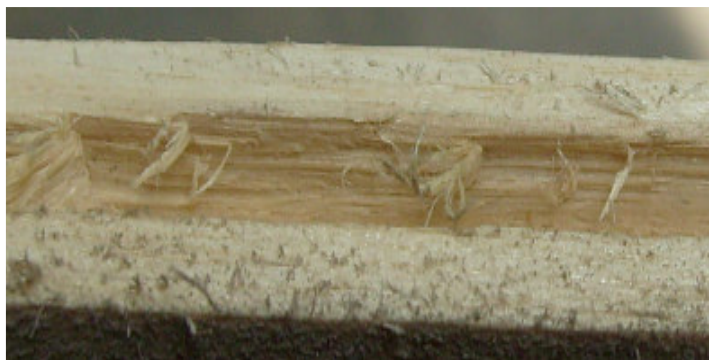
FOTO 6: DEFECTO DE GRANO ASTILLADO SUAVE EN EL ENSAYO DE MOLDURADO
