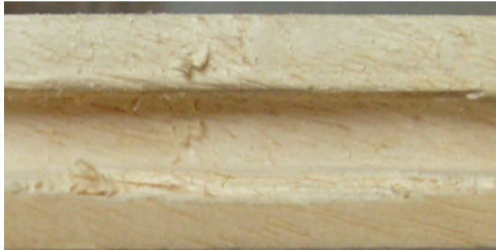
FOTO 2: DEFECTO DE GRANO ARRANCADO MODERADO EN EL ENSAYO DE MOLDURADO
