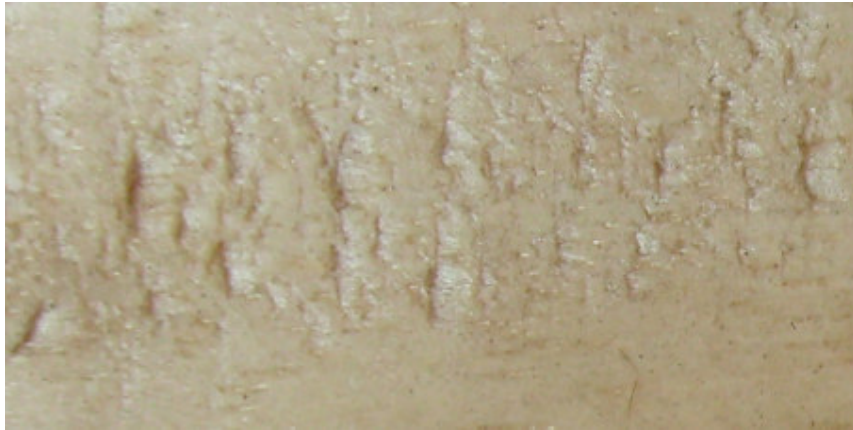
FOTO 1: DEFECTO DE GRANO ARRANCADO EN EL ENSAYO DE CEPILLADO
