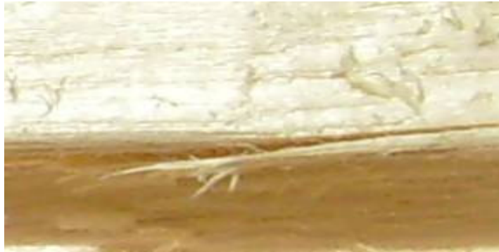
FOTO 8: DEFECTO DE GRANO LEVANTADO MODERADO EN EL ENSAYO DE MOLDURADO
