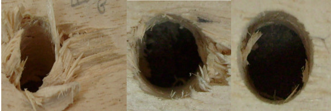
FOTO 1: DEFECTO RUPTURA DE GRANO FUERTE
