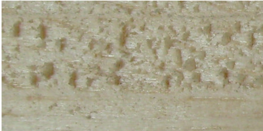
FOTO 2: DEFECTO DE GRANO ASTILLADO EN EL ENSAYO DE CEPILLADO
