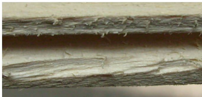
Figura 10 Defecto de grano arrancado en el Ensayo de Moldurado
