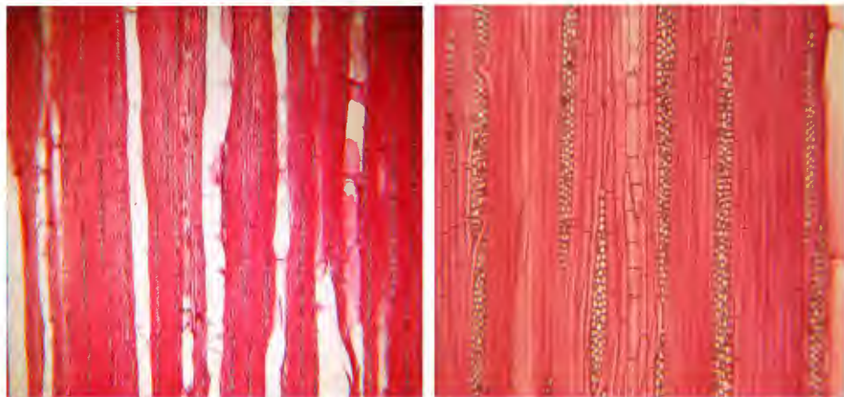
Figura 15 Corte tangencial de Oxandra xylopioides (40X y 100X)
