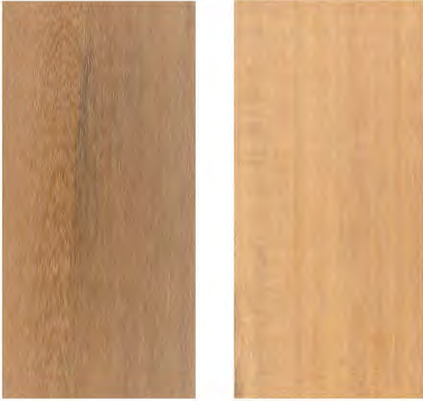
Figura 6 Madera en corte tangencial y radial de Licania Octandra
