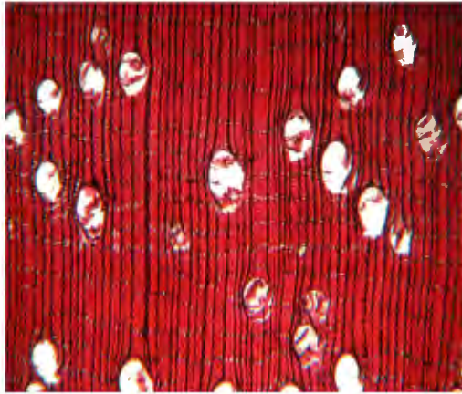
Figura 8 Corte transversal de Licania Octandra (40X)
