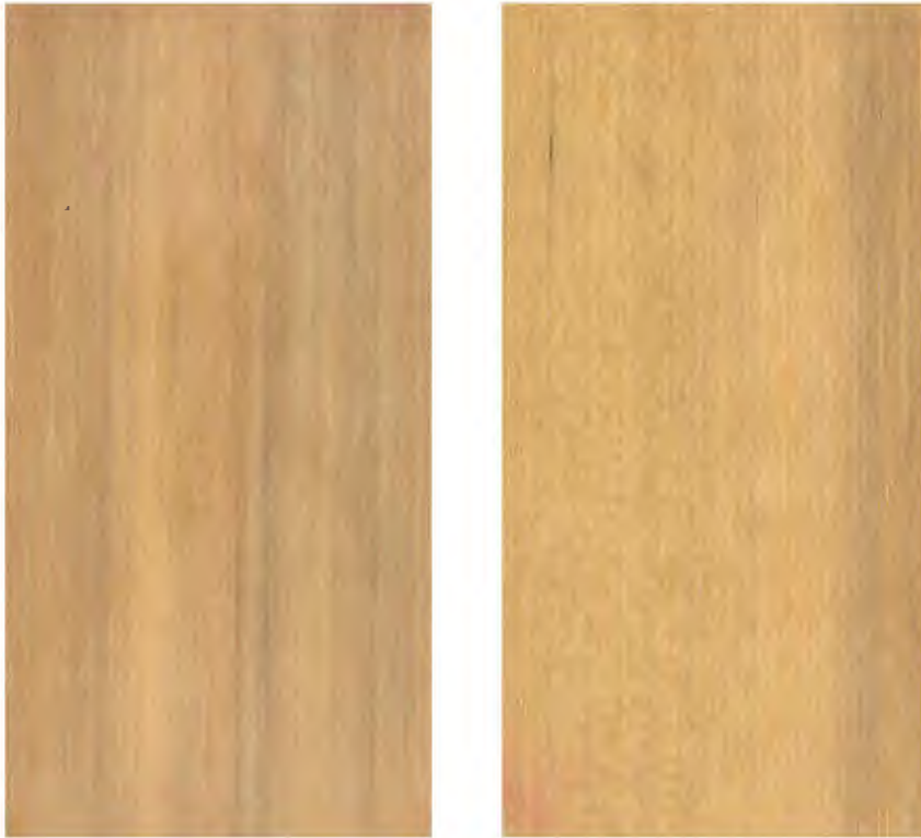
Figura 11 Madera en corte tangencial y radial de Oxandra xylopioides
