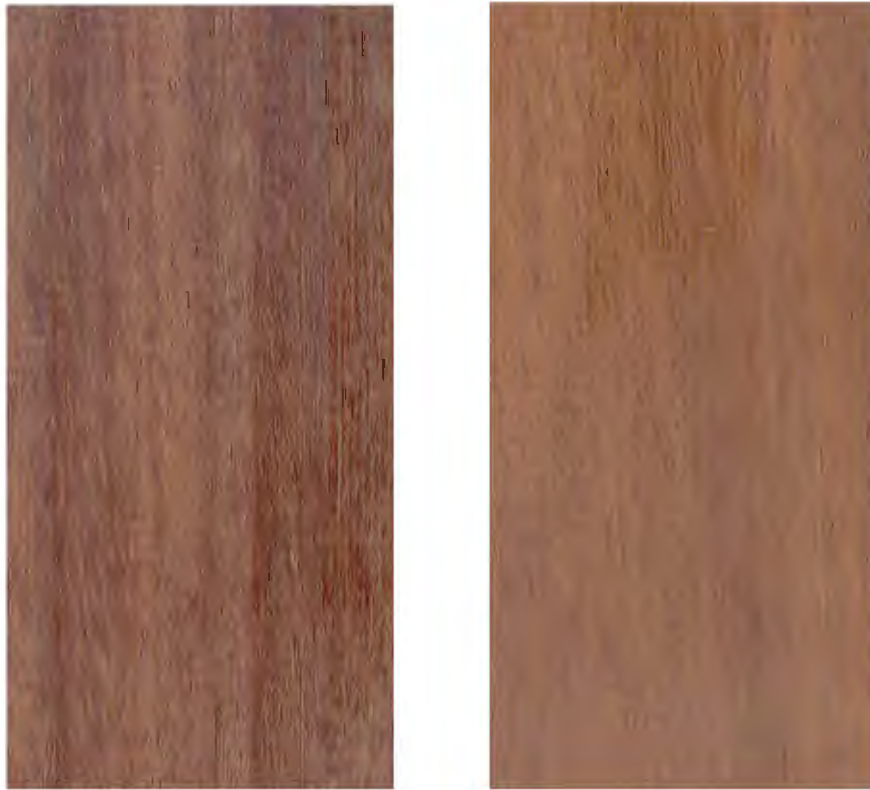
Figura 1 Madera en corte tangencial y radial de Hyeronima alchorneoides
