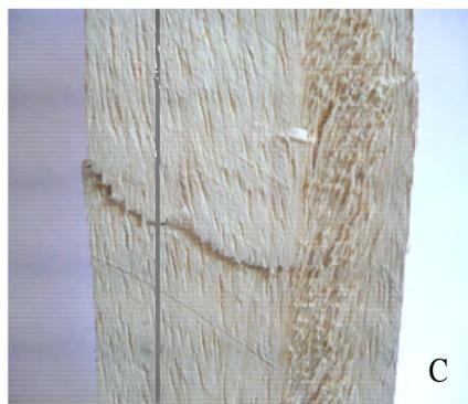
Probetas ensayadas de compresión paralela
