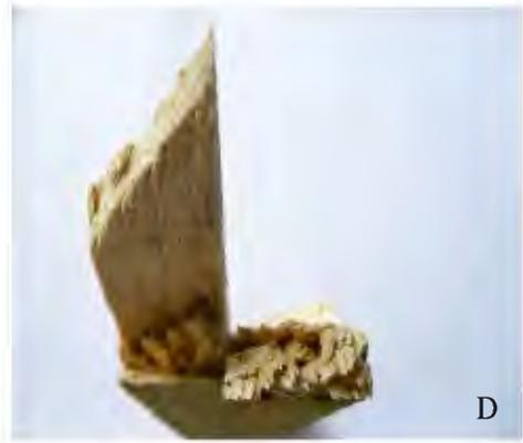
Probeta ensayada de Tenacidad
