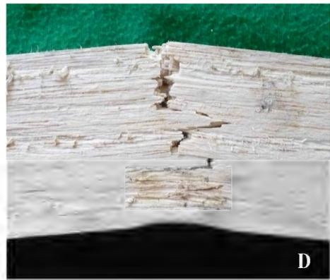
Probeta ensayada de flexión estática
