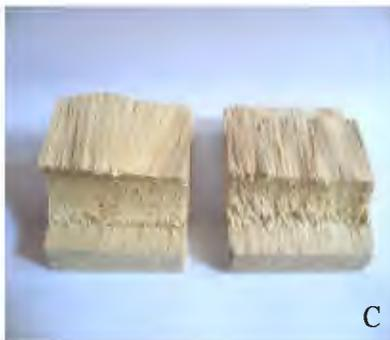
**A.** Probeta ensayada de cizallamiento. **B.** Probeta ensayada de clivaje. **C.** Probeta ensayada de tensión perpendicular.
