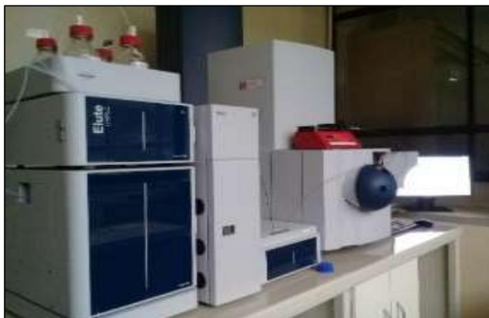
**Figura 21:** Equipo HPLC- ESI Q TOF MS/MS utilizado en el ensayo
