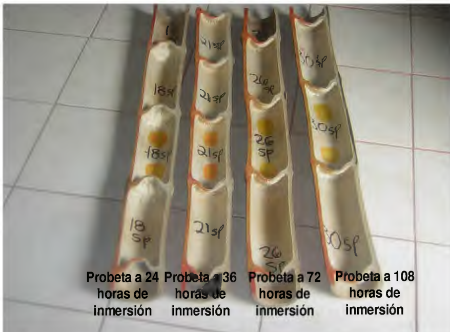
Figura 5 Penetración en probetas de bambú sin perforar (SP) por el método de inmersión prolongada a 24, 36, 72 y 108 horas.
