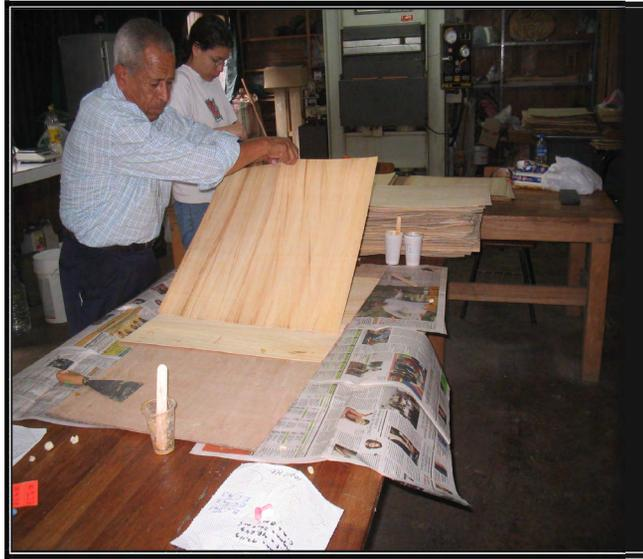
**Figura 17** Ensamblado de los tableros
