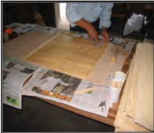
**Figura 16** Extendido de la mezcla encolante
