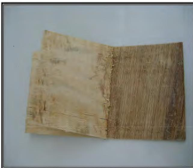
**Figura 26** Calidad de ligadura 0 en probeta de ensayo físico de capinurí
