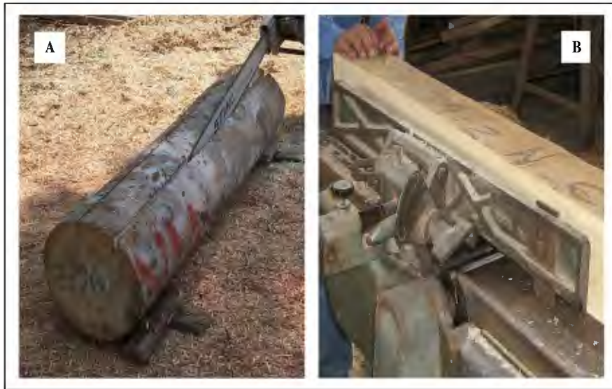
Figura 5 Transformación de trozas a viguetas (A) Corte longitudinal de las trozas para la obtención de tablones de sección 5 pulgadas x ancho variable y 4 pies de longitud (B) Escuadrado de los tablones para la obtención de las viguetas.
