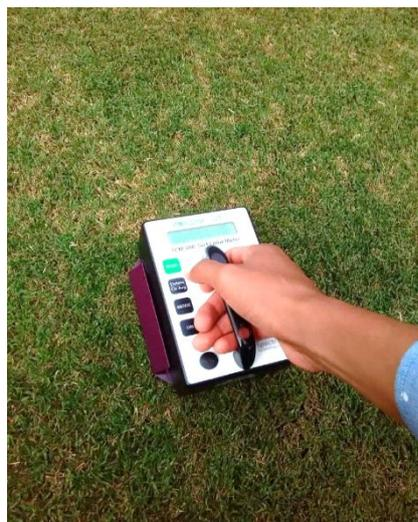
**Figura 7: Prueba de medidor de calidad de césped TCM 500 NDVI**
