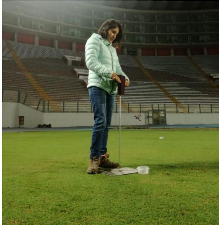
**Figura 4: Sensor de compactación del suelo SC 900**
