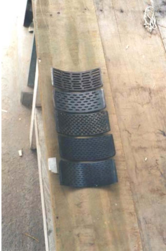
**Figura N° 8: Mallas metálicas para la obtención de partículas para la elaboración de tableros**
