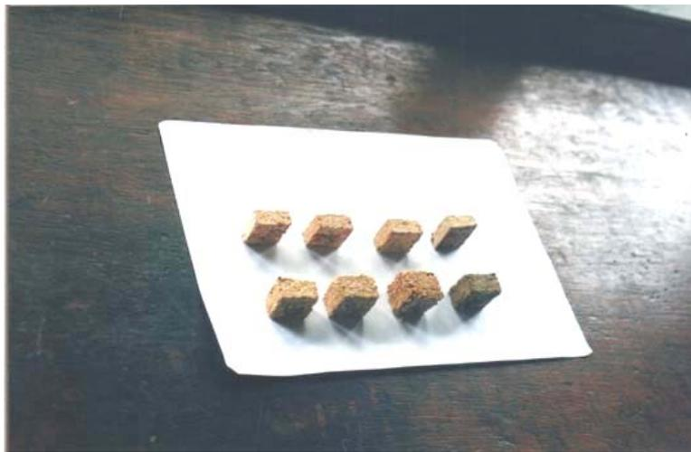
**Figura N° 11: Probetas de tableros de partículas para los Ensayos de estabilidad dimensional**
