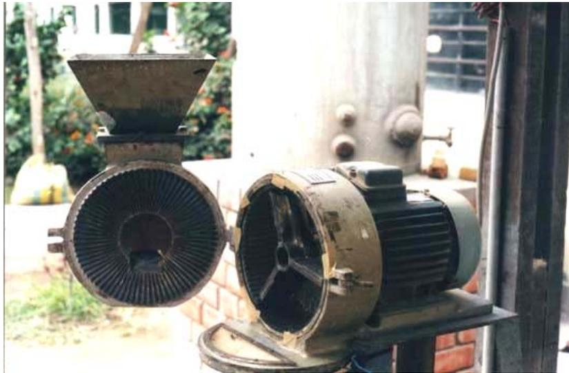
**FIGURA N° 5: Molino de aspas para la obtención de partículas para la elaboración de tableros**
