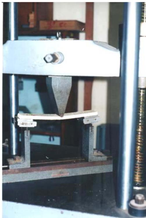
**Figura N° 7: Ensayos de flexión estática en la prensa universal “TINIUS OLSEN”**
