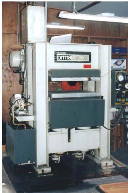
**Figura N° 6: Prensa de platos calientes ORMA MACCHINE**
