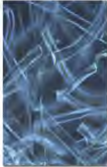
Figura 1 Imagen microscópica de fluorescencia de fibras de kapok Fuente: Olympus Microscopy Resource Center, 2006
