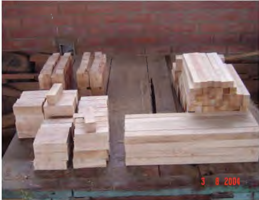
Figura 12: Probetas de propiedades físicas, cizallamiento, flexión estática, tenacidad y compresión paralela
