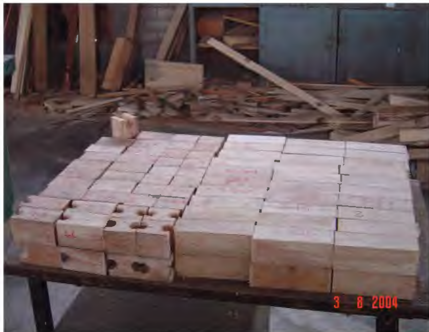
Figura 13: Probetas de clavaje, tensión perpendicular, compresión perpendicular, dureza y extracción de clavos
