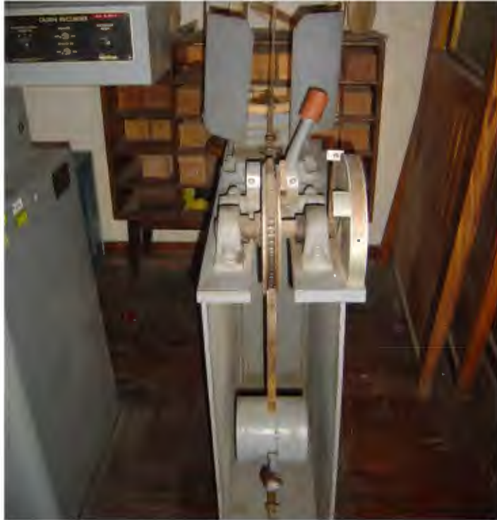
Figura 16: Probadora de tenacidad “Baldwin”
