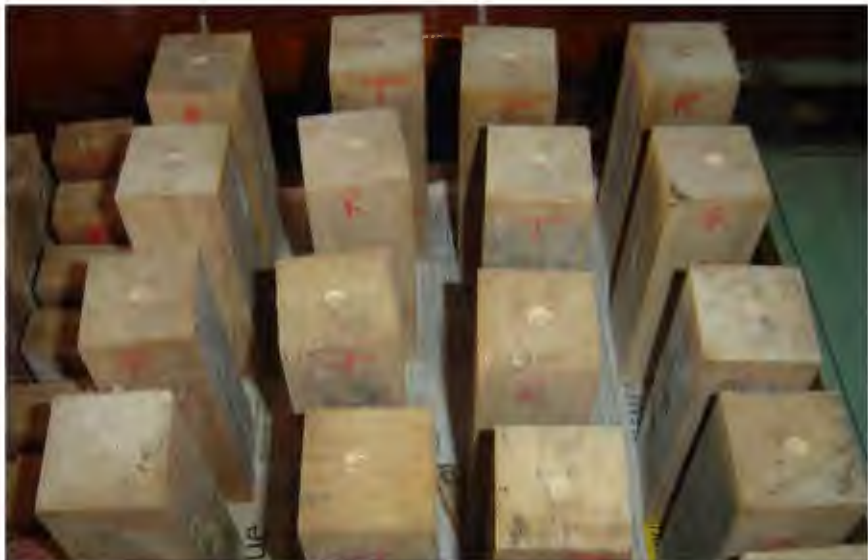
Figura 17: Probetas de dureza luego de sus respectivas pruebas de resistencia mecánica
