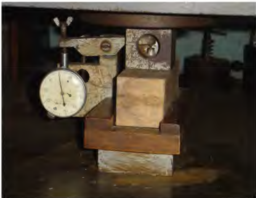
Figura 15: Prueba de compresión perpendicular a las fibras
