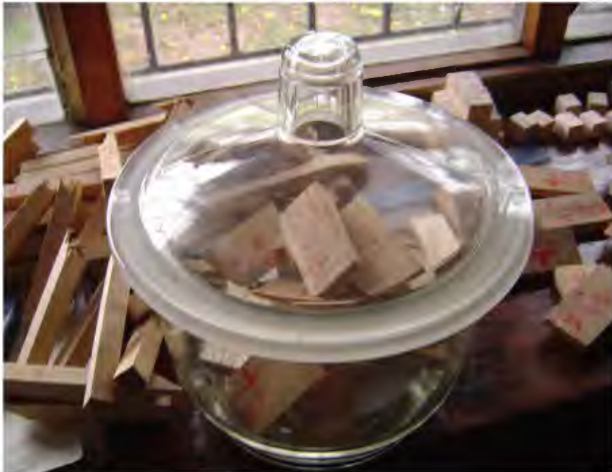
Figura 19: Probetas de resistencia mecánica en campana desecadora
