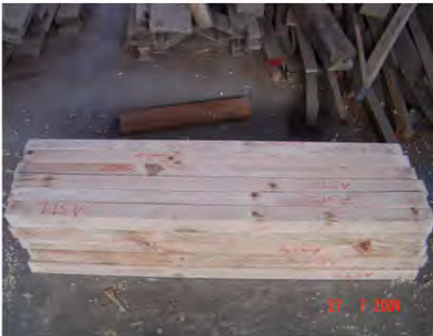
Figura 11: Listones de 8 x 8 cm. antes de la selección para la elaboración de las diferentes probetas
