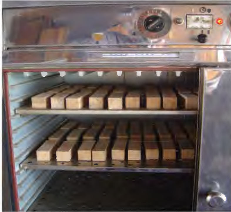
Figura 18: probetas de propiedades físicas en la estufa eléctrica
