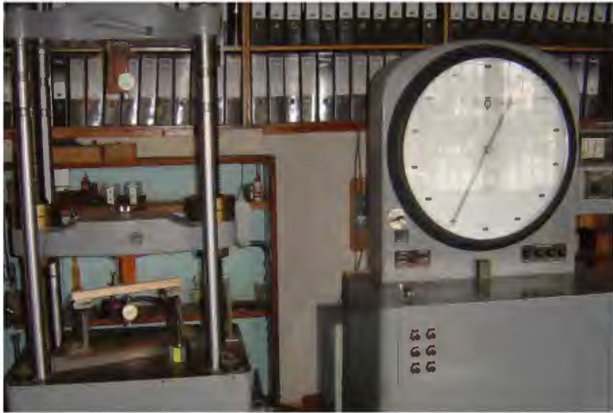
Figura 14: Ensayo de flexión estática con prensa universal
