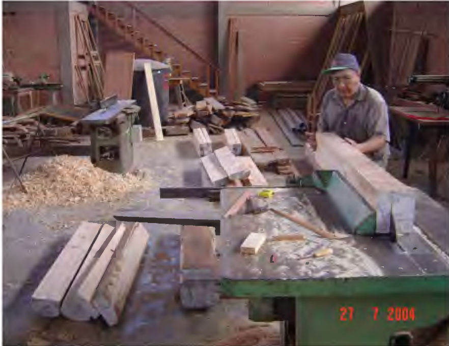
Figura 10: Aserrado de tablonces para elaborar listones de 8 x 8 cm.
