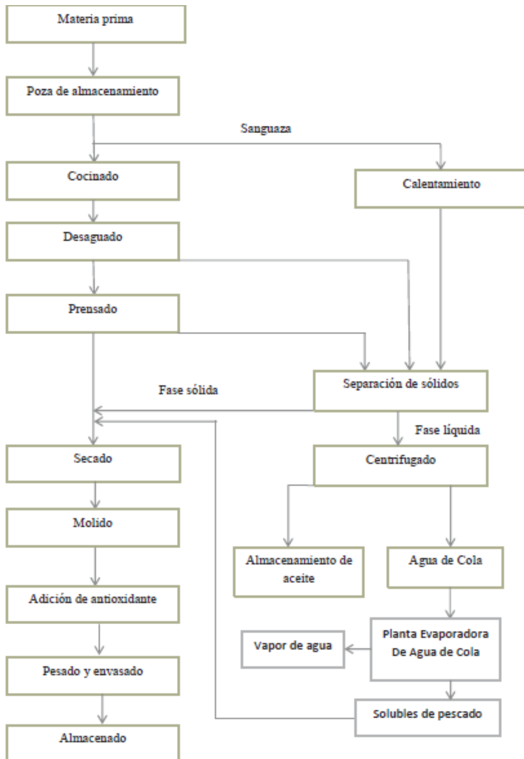
Figura 3: Flujo del proceso de elaboración de Harina de pescado
