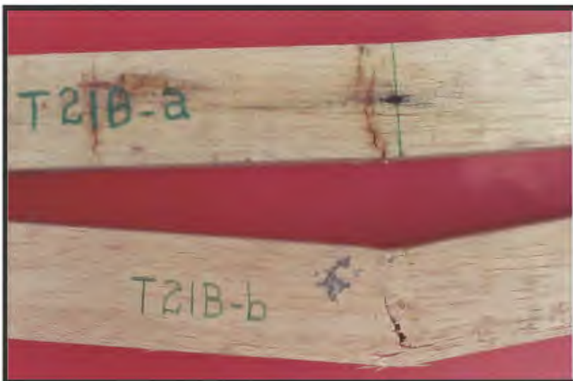
Figura 16 : Vistas de lados. En T21B-a se observa quebradura y en T21B-b la presencia de quebradura; pero en diferente grado, así como, la falla de la compresión en la zona superior de la probeta
