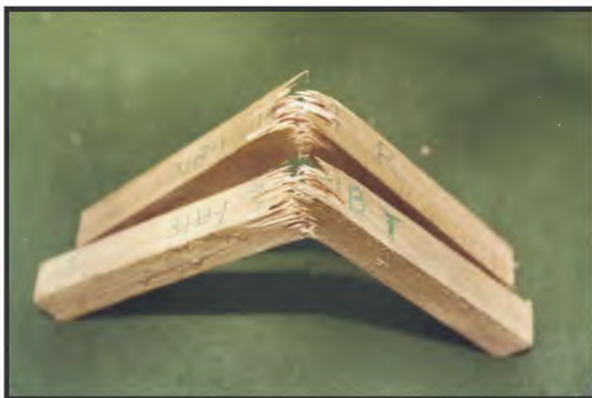
Figura 14 : Probetas de Tenacidad, T31B-1 radial y tangencial. En las que se observan fallas del tipo astilladura corta, correspondientes a la edad de 29 años
