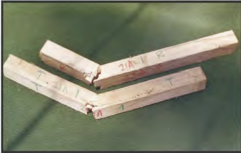
Figura 15 : Fallas del tipo quebradura en las probetas T21A-1 radial y tangencial para el ensayo de Tenacidad, correspondientes a la edad de 24 años
