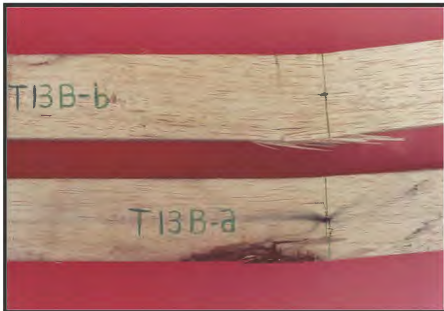
Figura 12 : Vista de lados de probetas de Flexión estática para la edad de 15 años. En probeta T13B-b, astilladura y en la probeta T13B-a, quebradura
