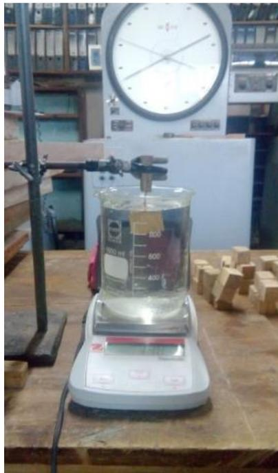
**Figura 1: Medición de humedad en probetas**
