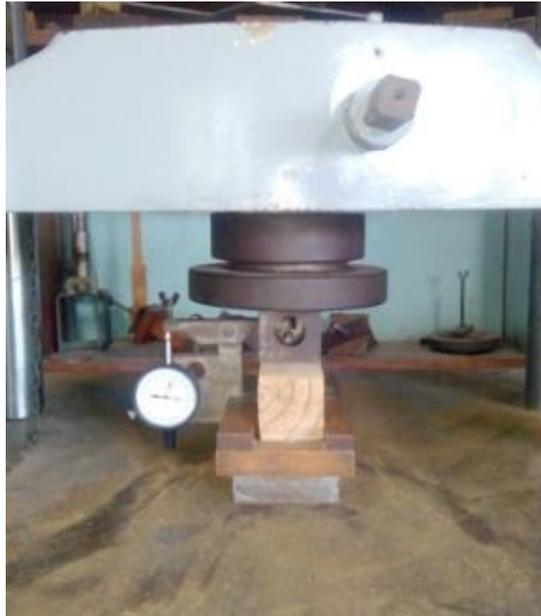
**Figura 3: Ensayo de compresión perpendicular**
