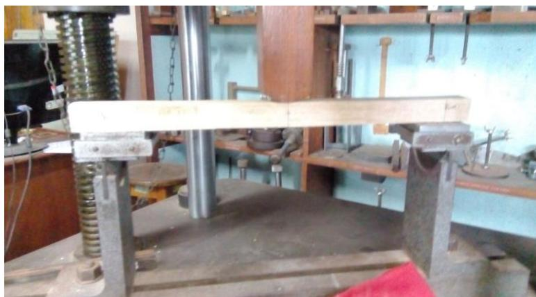
**Figura 2: Ensayo de Flexión Estática**
