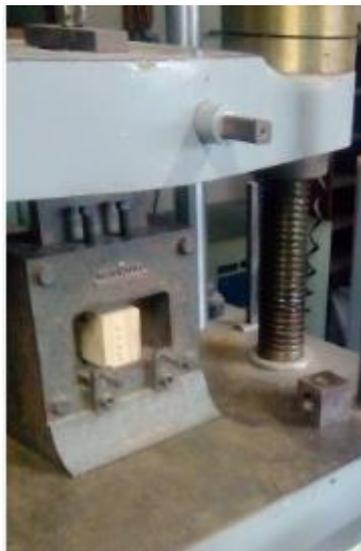
**Figura 4: Ensayo de Cizallamiento**
