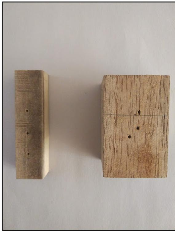
PROBETA DE CAPIRONA Y DE TORNILLO LUEGO DE ENSAYOS CON PILODYN
