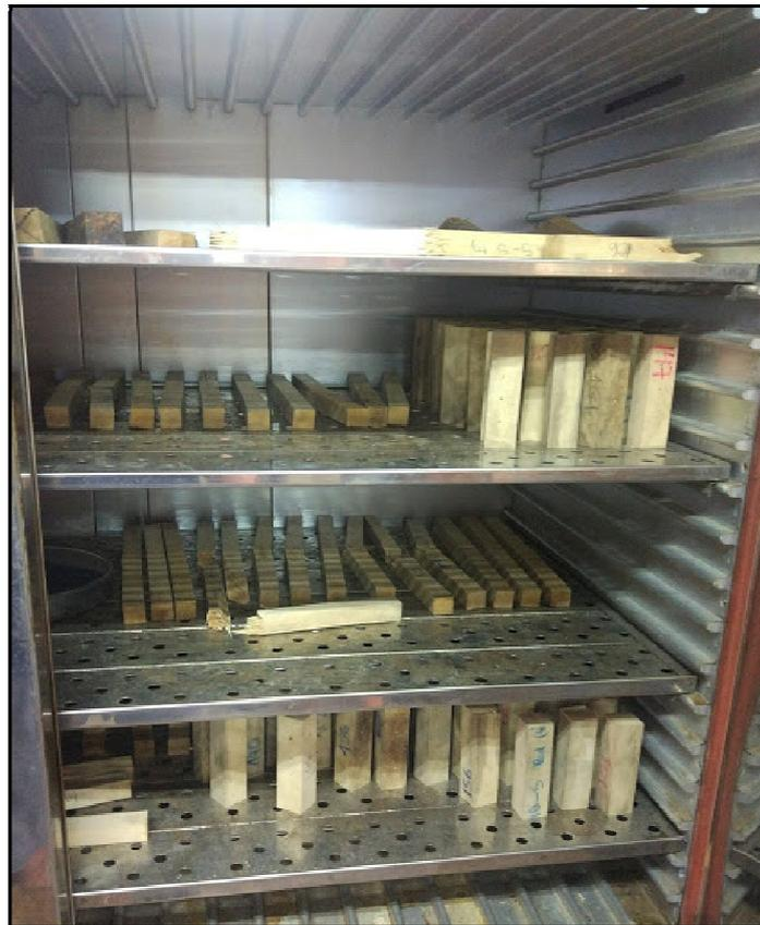
SECADO EN HORNO DE PROBETAS DE CAPIRONA
