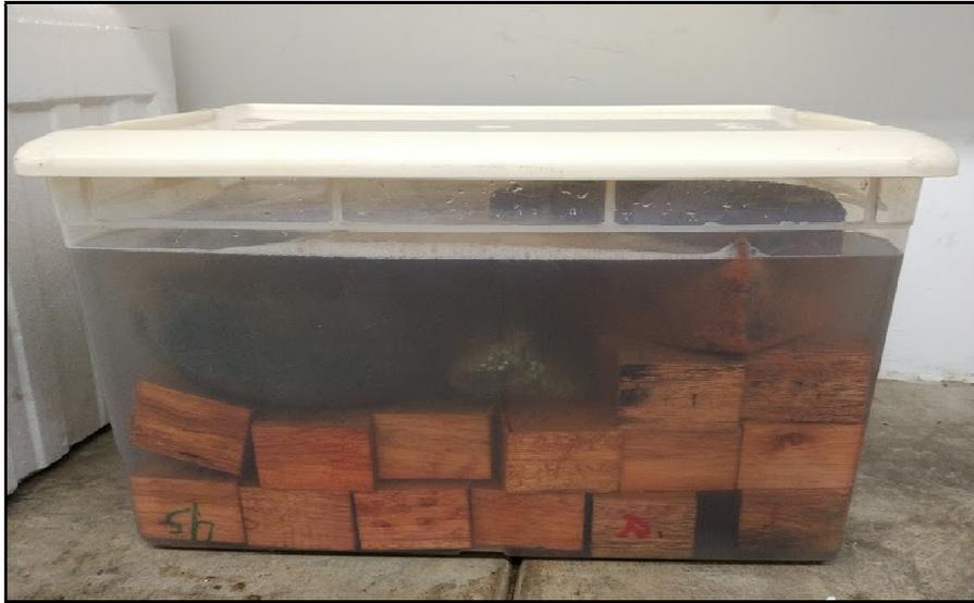
SATURACIÓN DE PROBETAS DE TORNILLO
