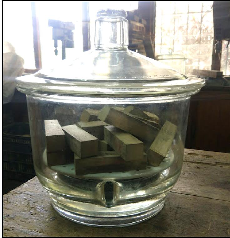
PROBETAS DE CAPIRONA EN DESECADOR CON SÍLICAGEL
