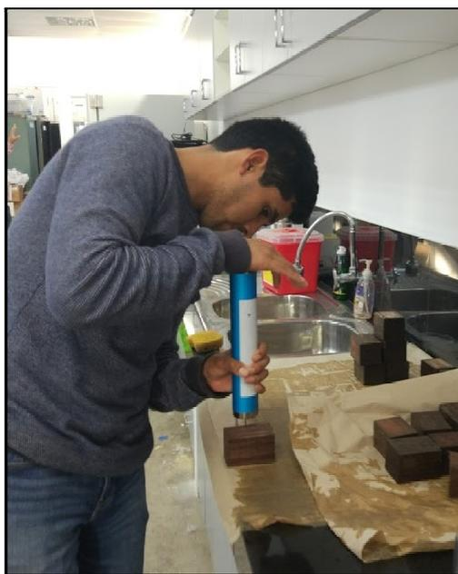
**Figura 13: Evaluación de probeta de Tornillo en condición saturada con Pilodyn**
