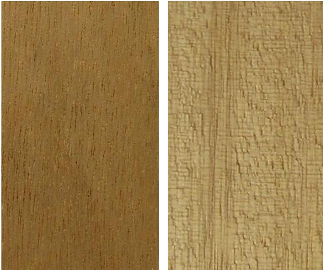
**Figura 9:** Madera en corte tangencial y radial de *Dracryodes peruviana*
