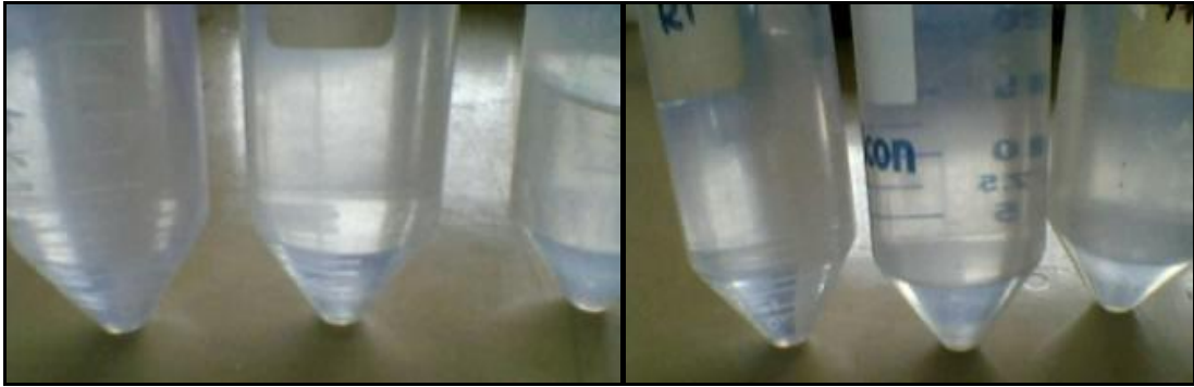
Figura 2: Muestras de extracto de aceite de fuente del INIA (a) y de fuente comercial (b) después de centrifugación siguiendo metodología de prueba hemaglutinación.
