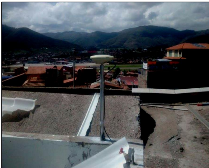
Imagen N°2: Estación de GPS Base, ubicado en la Ciudad de Cusco.
