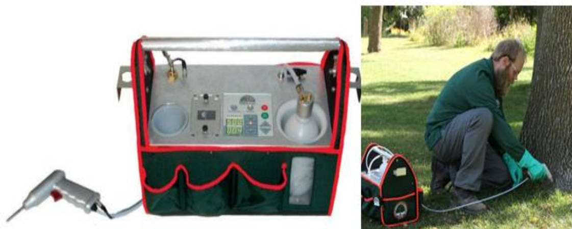
Figura 8: Sistema de macroinyección
