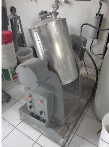
Figura 2: Digestor del laboratorio de pulpa y papel de la UNALM
