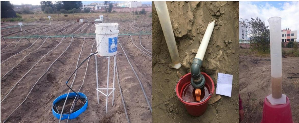
**Figura 3.10:** Lisímetro de drenaje, Riobamba, Ecuador, 2018.
