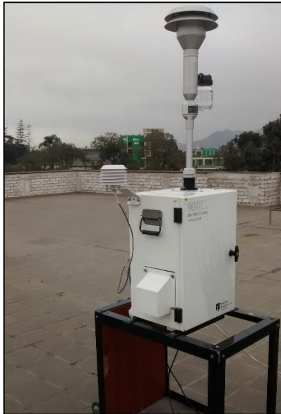
Fotografía 2: Muestreo de PM 2.5 en el punto P2
