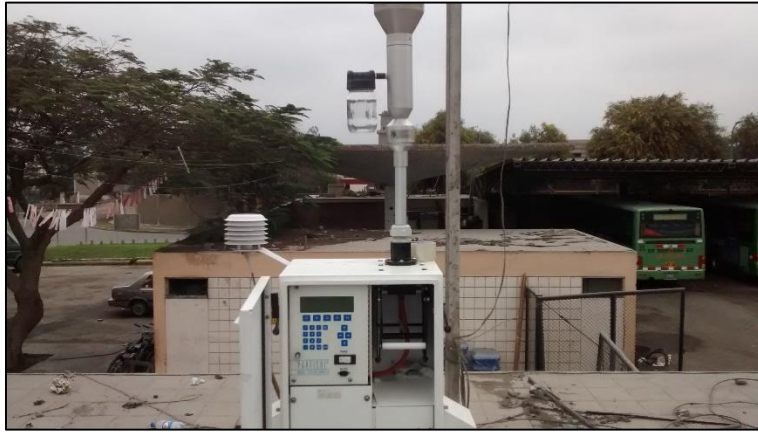
Fotografía 5: Muestreo de PM_{2.5} en el punto P5
