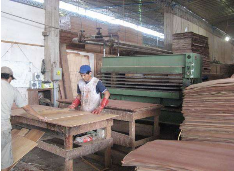
Figura 8: Ensamblado del tablero
