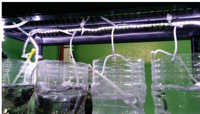
Figura 11. Sistemas de cultivo de C. chamissoi . Botellas de 4 L con aireación y luces LED.
