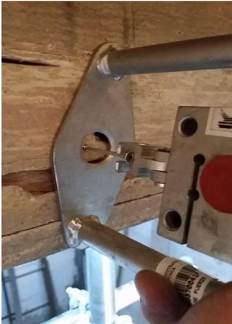
Figura 17: Medición en la cara lateral de la pieza
