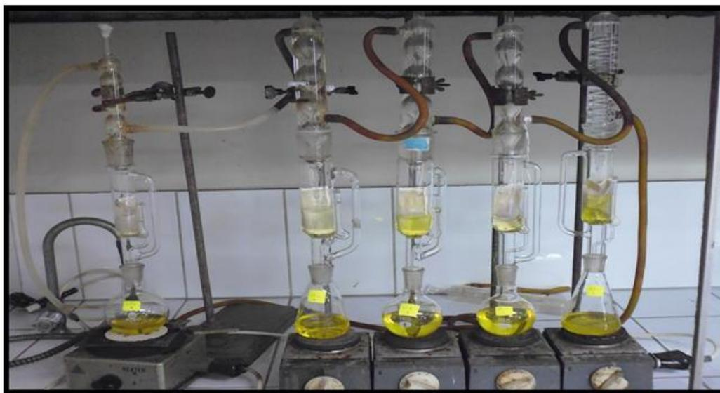
Figura 15: **Obtención de lípidos en equipo Soxhlet.**
