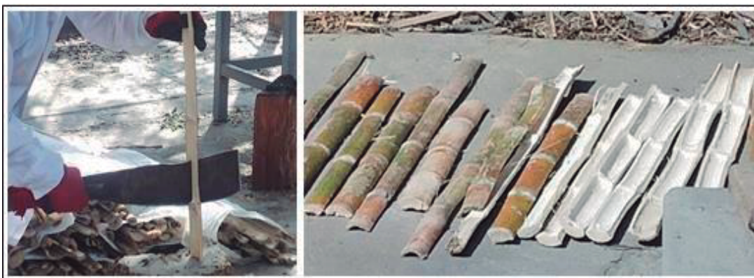
Figura 17: Obtención de secciones de cañas de guadua
