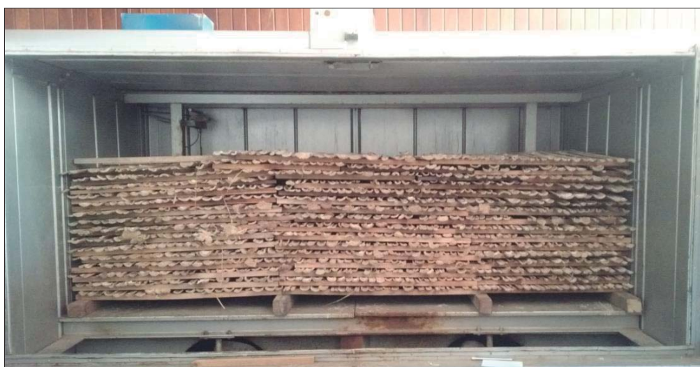
Figura 18: Secciones de caña de guadua apiladas en el horno de secado
