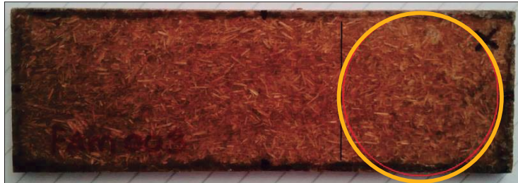
Figura 25: Probeta para ensayos físicos: zona marcada para la medición de color.
