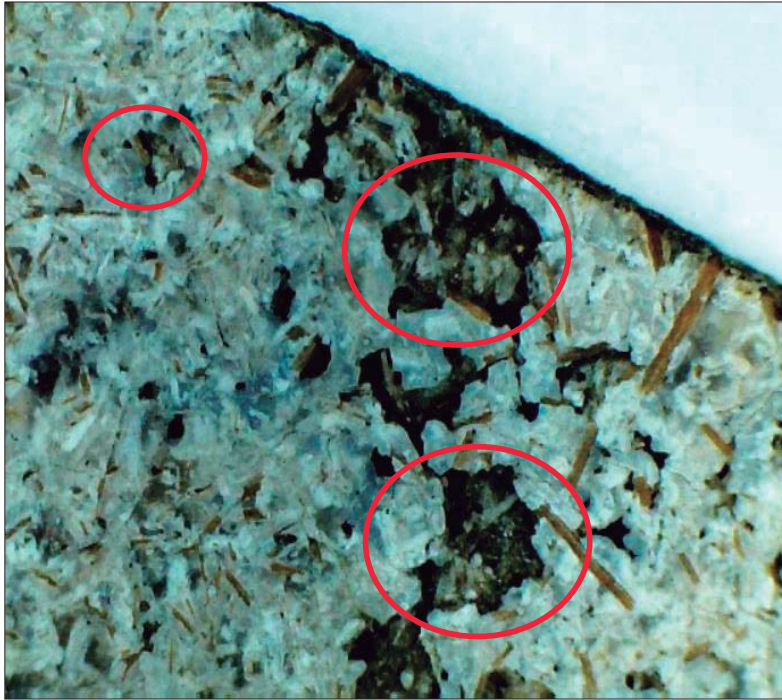
Figura 36: Superficie del compuesto bambú-plástico, erosionada y con grietas, después del intemperismo.
