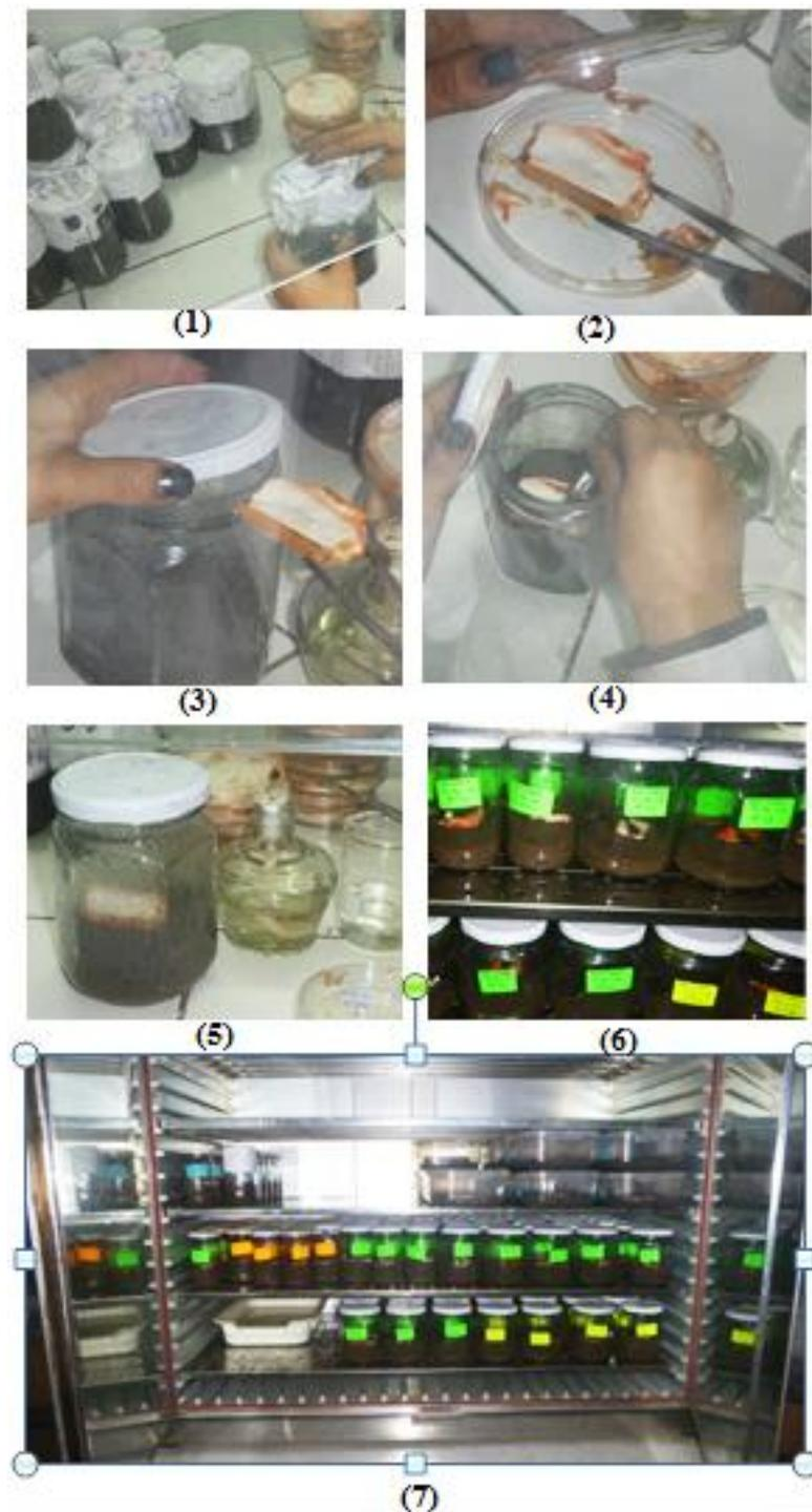
Figura 27: **Preparación de botellas de ensayo de la prueba de degradación biológica.**
