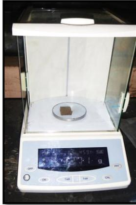
Figura 22: **Balanza analítica con pesado de probeta bambú-plástico.**
