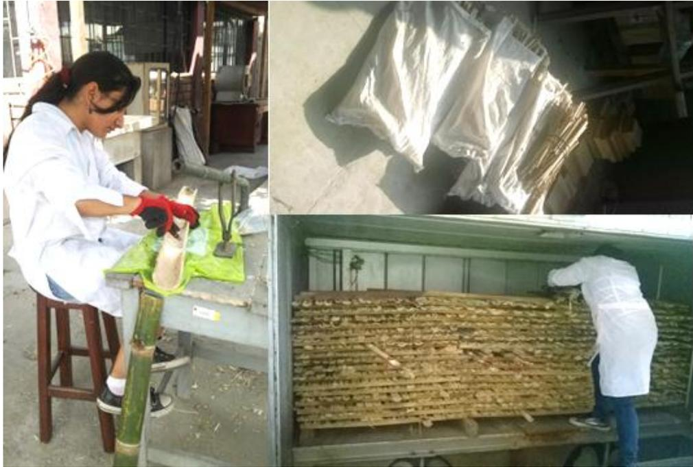
Figura 13: **Acondicionamiento y secado de los culmos de bambú.**
