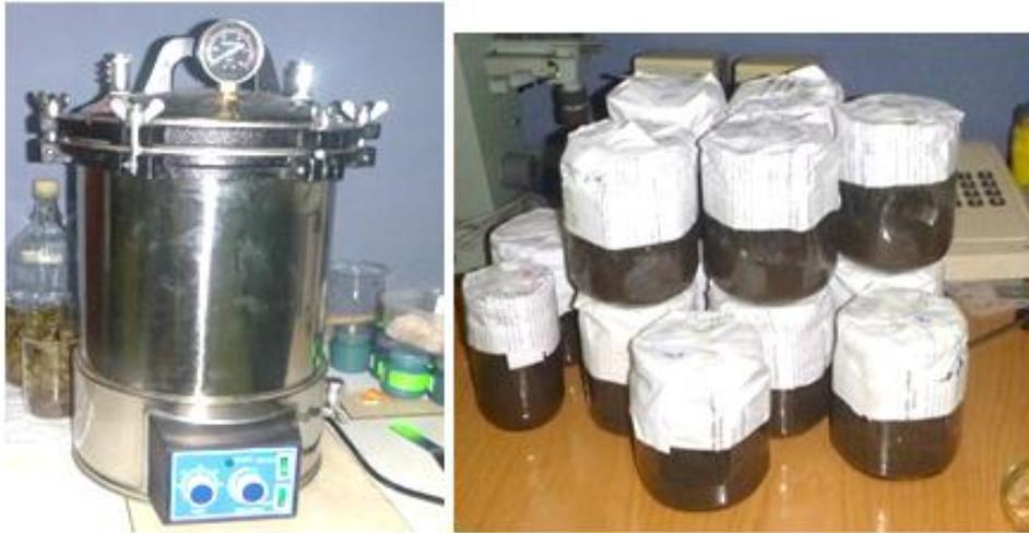
**Figura 26: Esterilizador de vapor de presión portátil y frascos de prueba esterilizados.**
