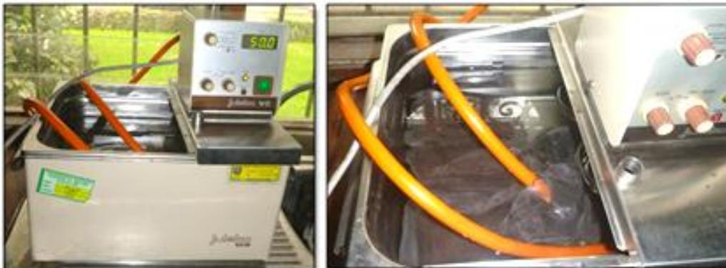
Figura 23: **Probetas bambú-plástico sumergidas en equipo de baño maría.**
