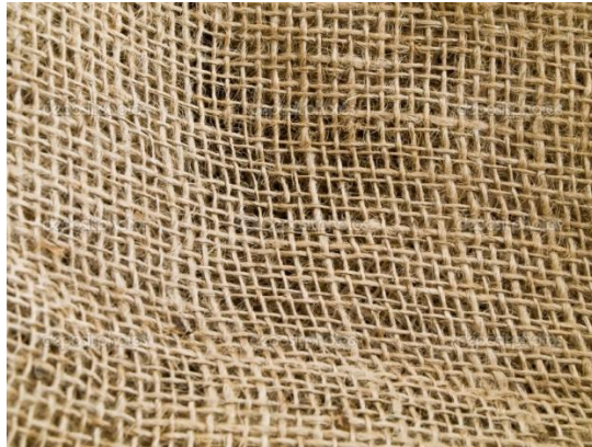
Figura. 10 Malla tejida con fibra natural. Fuente: Otero, 2000.
