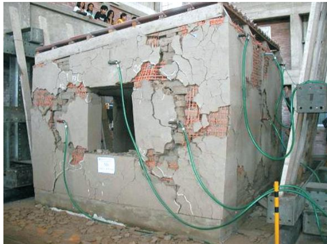
Figura. 9 Ensayo experimental de falla por corte. Fuente: Blondet, 2004.
