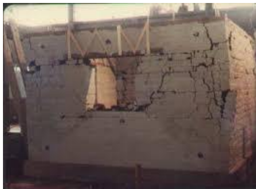
Figura. 6 Ensayo sísmico a escala real. Fuente: Blondet (2004).
