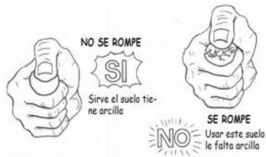
Figura. 4 Ensayo de Resistencia Seca. Fuente: Blondet y García, 2003.
