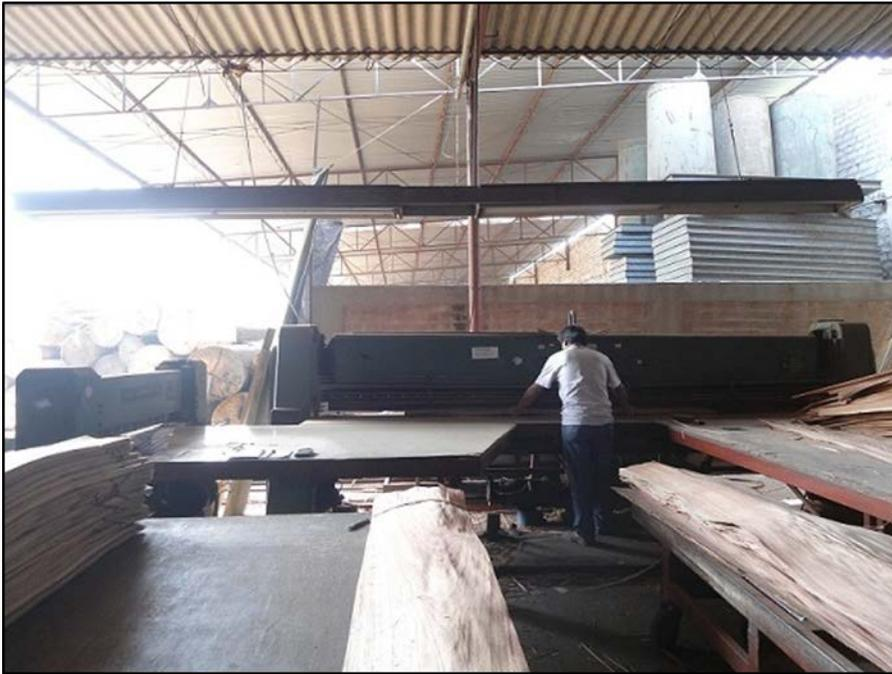
**Figura 12:** Guillotinas a pedal para dimensionar en ancho y largo
