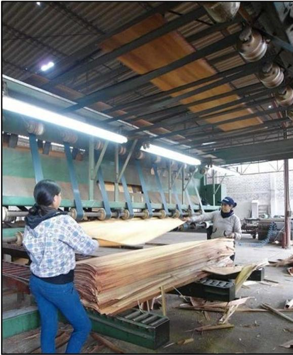
**Figura 9: Recepción de chapas obtenidas del flitch**
