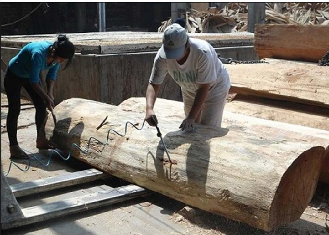
**Figura 5:** Descortezado manual de un flitch
