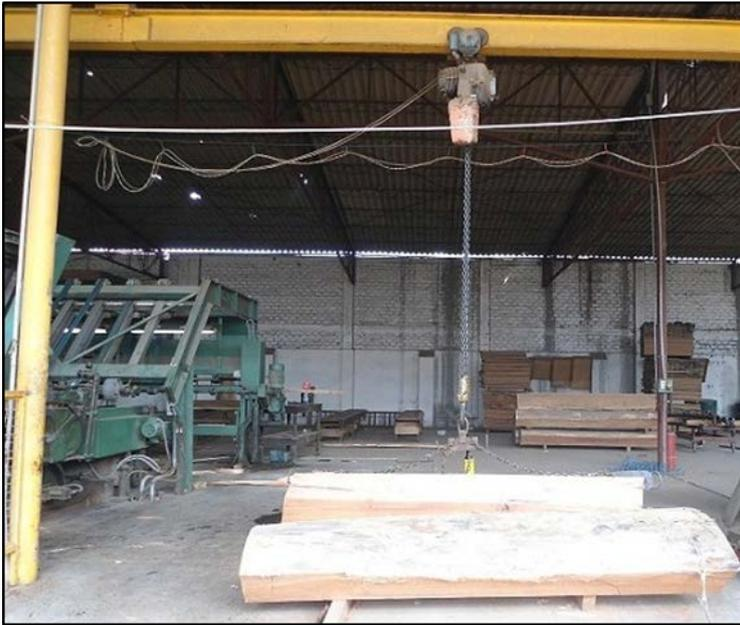
**Figura 6:** Cargado del flitch utilizando un winche eléctrico y corredizo sobre un monorraíl elevado
