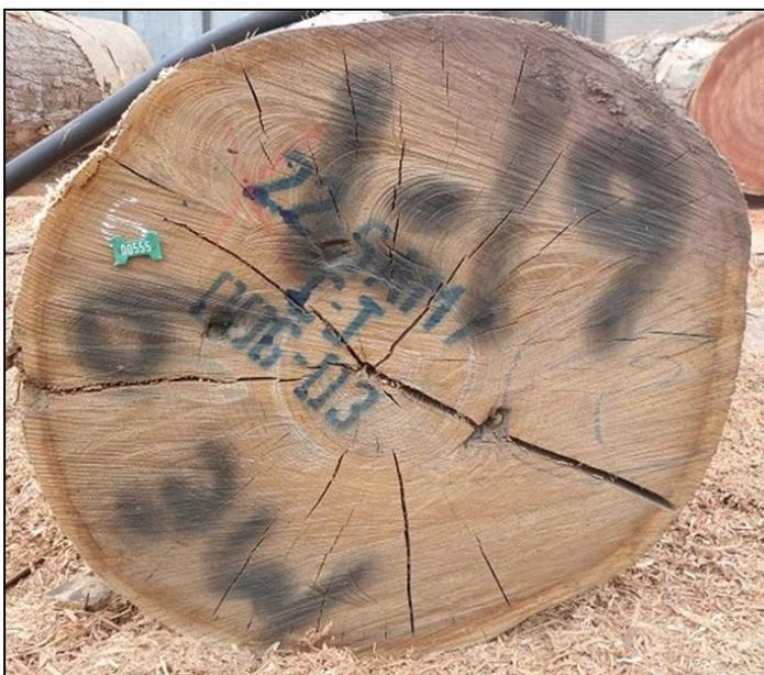
**Figura 2: Sección transversal de una troza de “cedro virgen” de calidad B**
