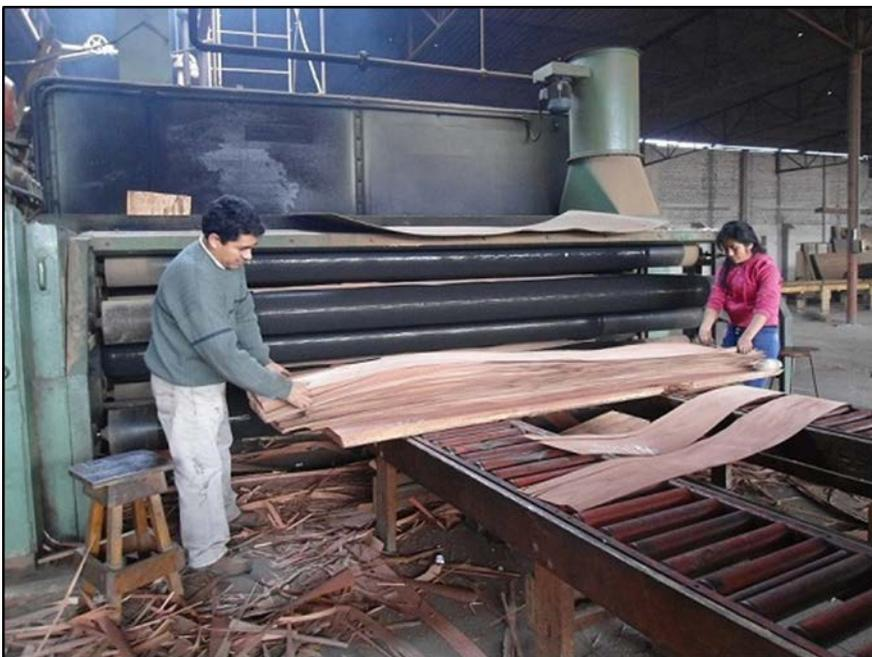
**Figura 11:** Recepción de las chapas del secador de mallas
