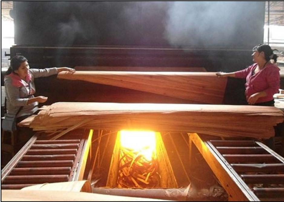
**Figura 10:** Alimentación de las chapas en el secador de mallas
