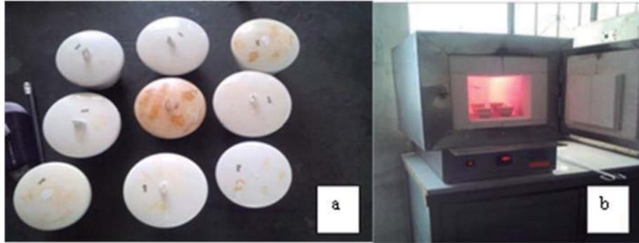
**Figura 20: Ensayo de material volátil**
