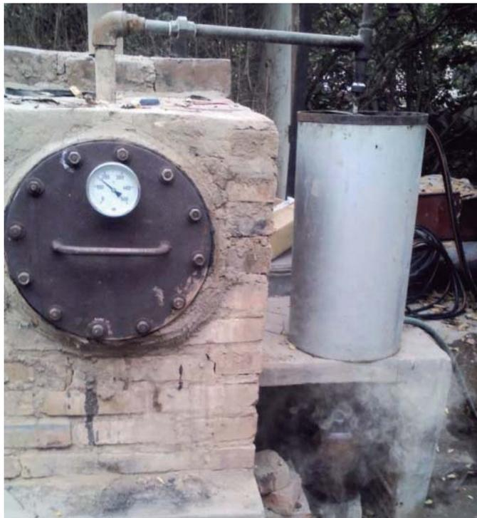
**Figura 16:** Equipo de destilación seca en retorta metálica usado en el estudio.
