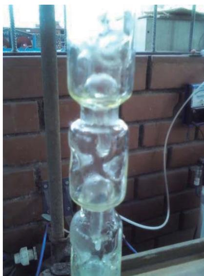
**Figura 23:** Columna de destilación fraccionada para obtención de acetona-metanol
