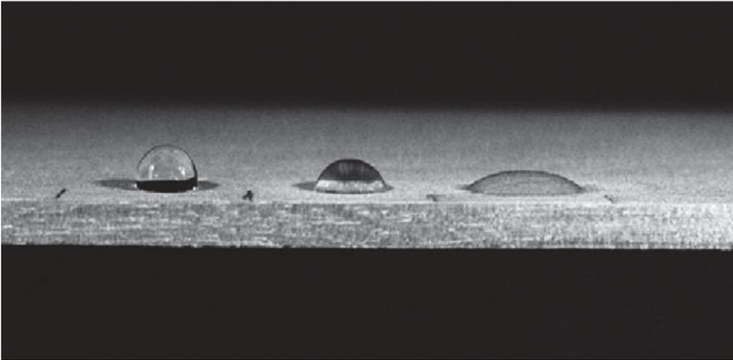
**Figura 4:** Gotas de agua muestran el mejor extendido de la superficie de la chapa por remoción de contaminantes. La gota de la izquierda sobre una superficie sin tratar, la del medio presenta dos pasadas de lija, y la gota de la derecha fue lijada por cuatro pasadas. .
