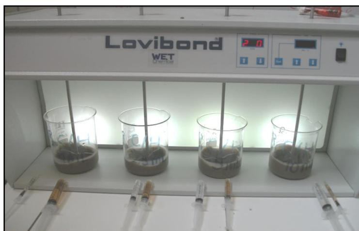
**Figura 33: Evaluación de la mezcla del Compuesto C con diferentes cantidades del Compuesto H en el tratamiento de agua de cola**
