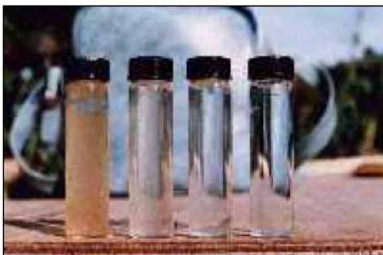
**Figura 6: Comparación entre muestras de agua cruda y tratada con *Moringa oleifera***
