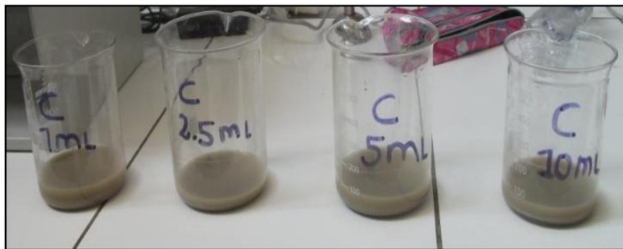
**Figura 21: Precipitado en el agua de cola tratada empleando diferentes cantidades de Compuesto C**
