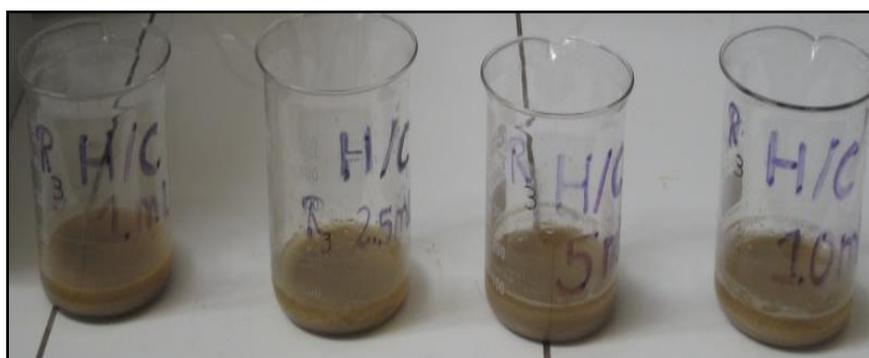
**Figura 32: Precipitación de sólidos del agua de cola tratada con mezcla de 1 ml del Compuesto C con diferentes cantidades del Compuesto C**
