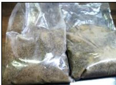
**Figura 49: Sólidos recuperados (lodo recuperado con 10% de humedad)**
