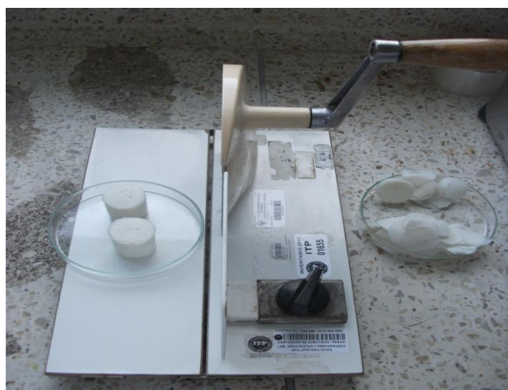
Figura 17. Cortado de geles de pota para la prueba de doblez
