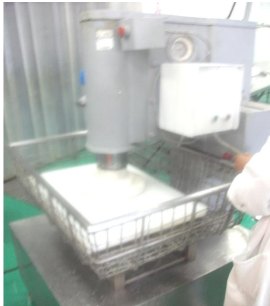
Figura 11. Prensado de la carne lixiviada de manto de pota
