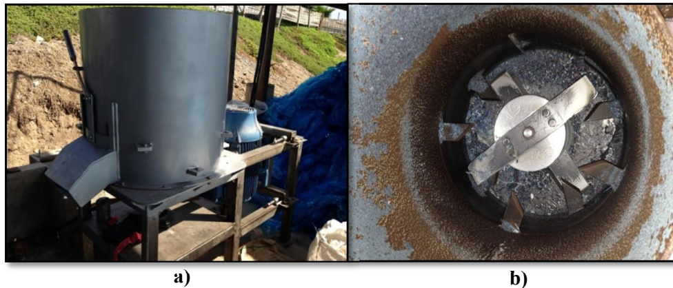
Figura 3: Máquina aglomeradora de plástico.
