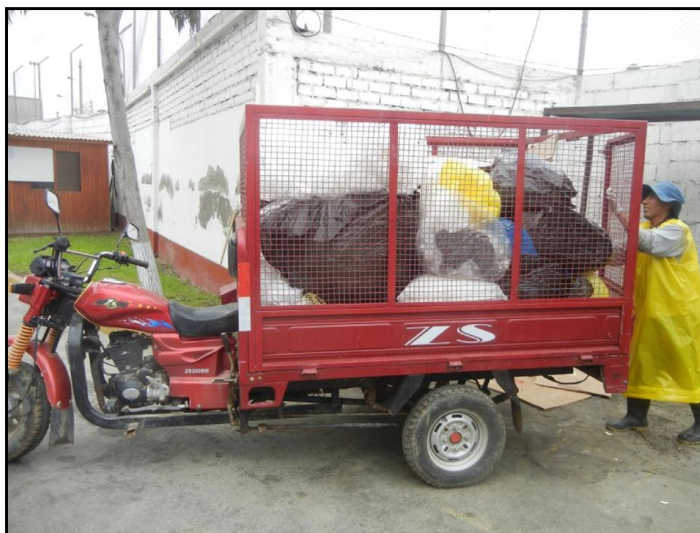
Figura 12: Unidad motorizada utilizada en la recolección y transporte de RRSS.
