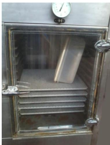
Figura 10: Cámara de germinación
